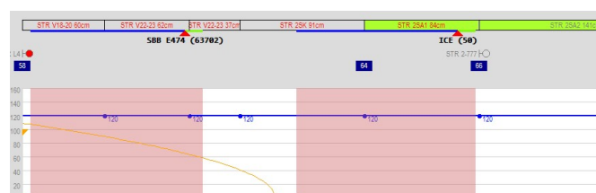
Obr. 8 Zobrazení brzdných křivek jízdy vlaků pod dohledem systému ETCS v úrovni 3 (flexibilní řízení provozu s pohyblivým blokem)
