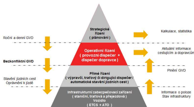
Obr. 9 Struktura úrovní systému řízení železniční dopravy
