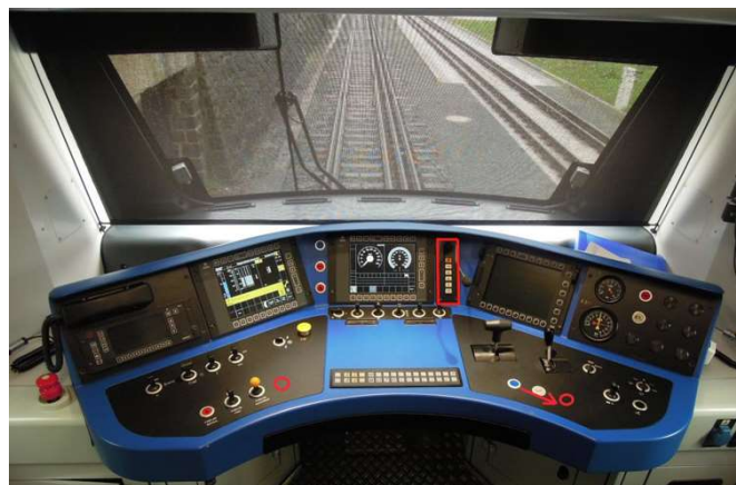
Obr. 11 Kokpit simulátoru kolejových vozidel (zdroj: Škoda Transportation, a.s.)
