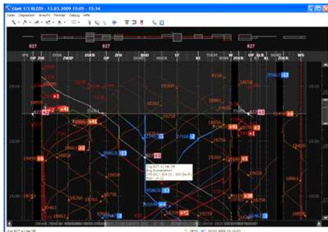
Obr. 10 Grafikon vlakových cest s predikcí jízdy vlaků a detekcí konfliktních cest.
